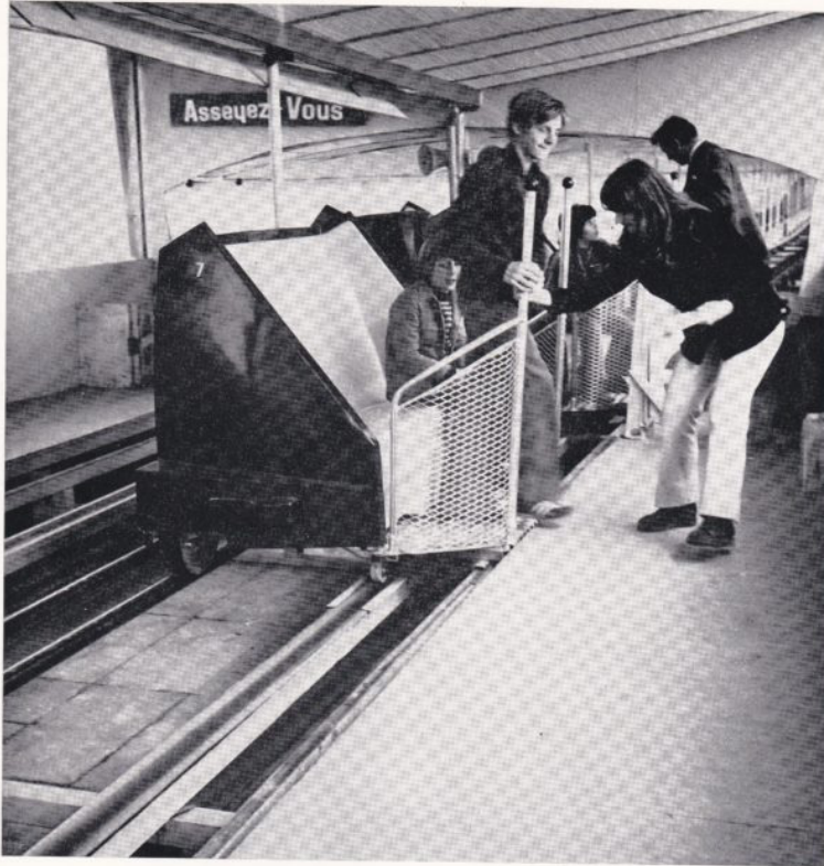
VUE DE LA STATION DANS LA ZONE DE DECHARGEMENT Les passagers descendent à leur aise et en s'amusant du véhicule qui défile à 0,35 m/sec.
